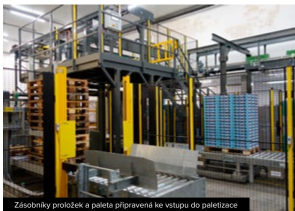
Zásobník proložek a paleta připravená ke vstupu do paletizace
