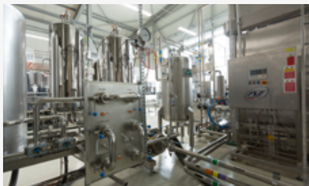
Poloautomatický mikrofiltrační systém s integrovanou automatickou sanitační jednotkou pro koncovou filtraci piva (studená stabilizace)
