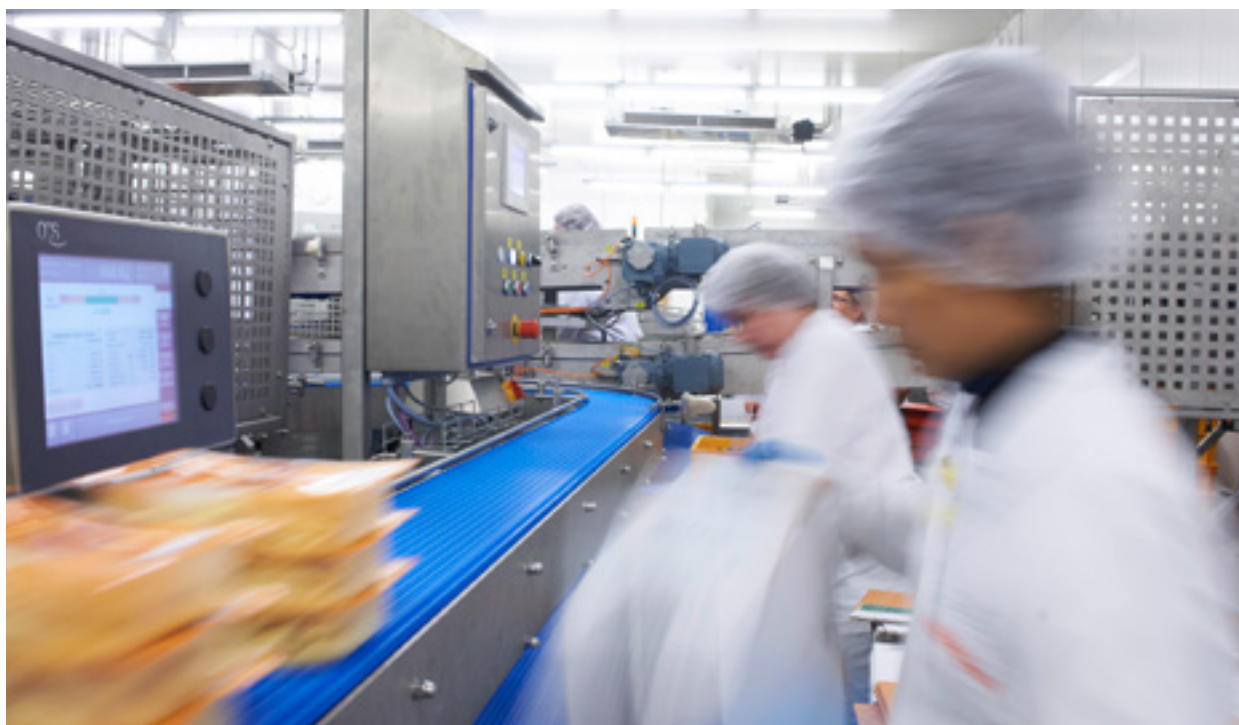
Výrobní linka s integrovanou rozváděčovou skříní Hygienic Design společnosti Rittal pro ochranu řídicí elektroniky v potravinářském provozu
