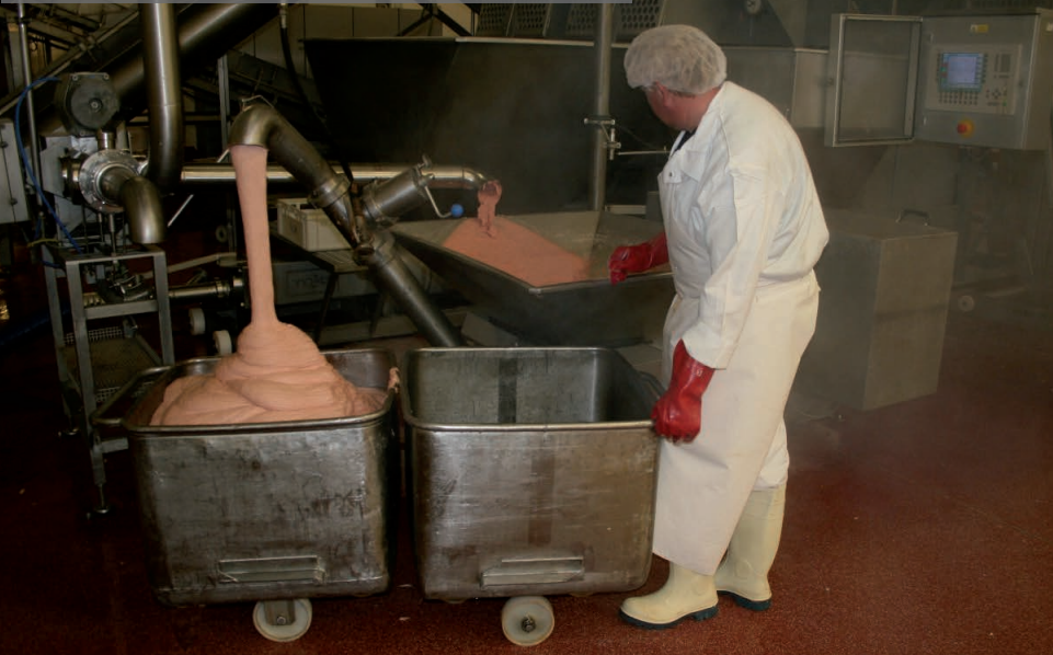
Výstup z plně automatické linky na standardizaci uzenářského díla.
