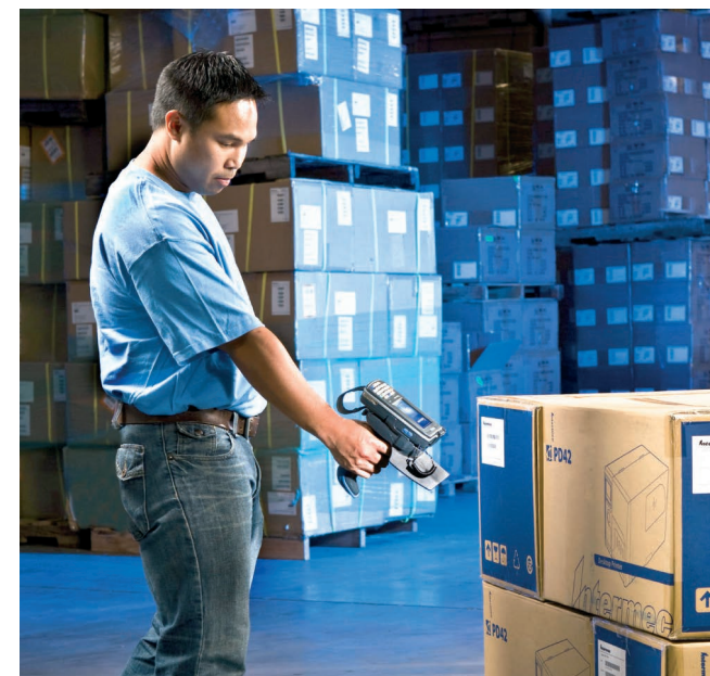
Snímače umožňující čtení informací uložených v čipu na RFID-tagu
