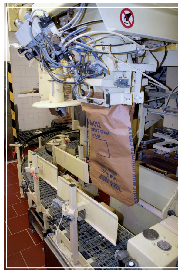
Plnění sušeného mléka do papírových pytlů o hmotnosti 25 kg – sušárna mléka NIRO.
