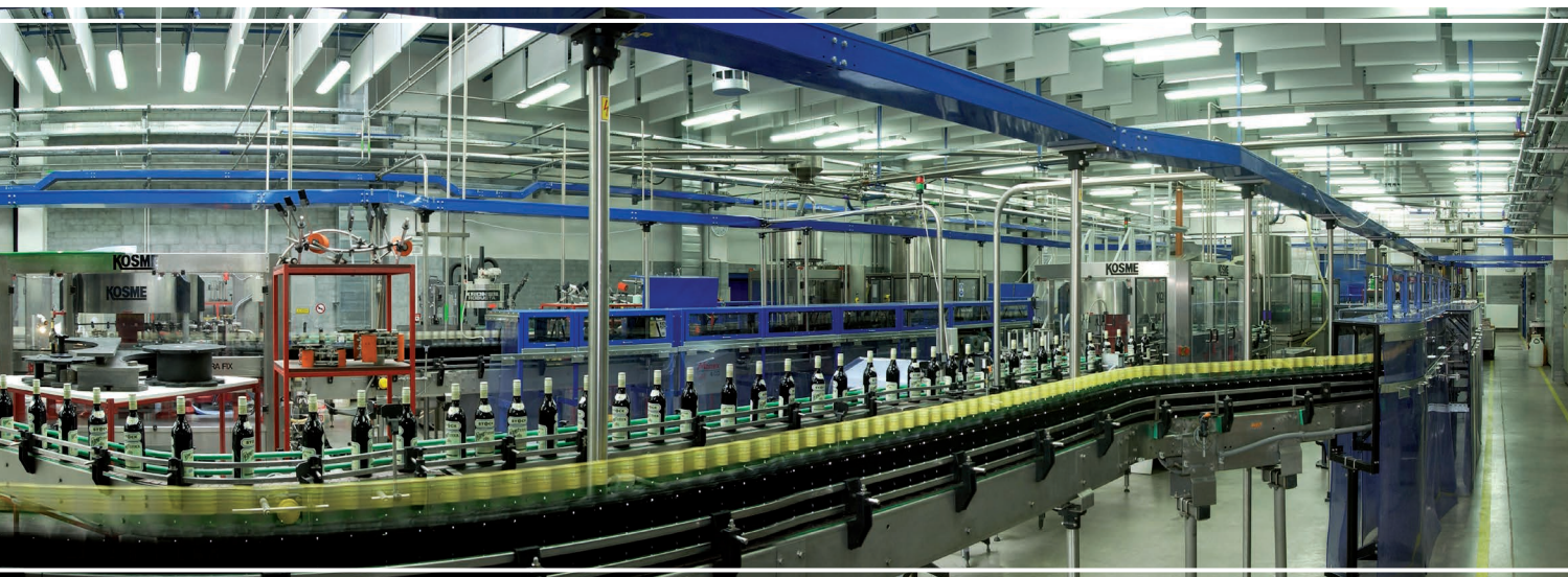
Linka č. 3. Jedna ze čtyř hlavních výrobních linek ve stáčírně Stocku Plzeň. Celková kapacita stáčení činí téměř 30 tisíc lahví za hodinu. Zde na lince právě Fernet Stock Citrus.
