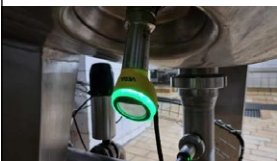
Měření tlaku v potravinářství VEGABAR 38
