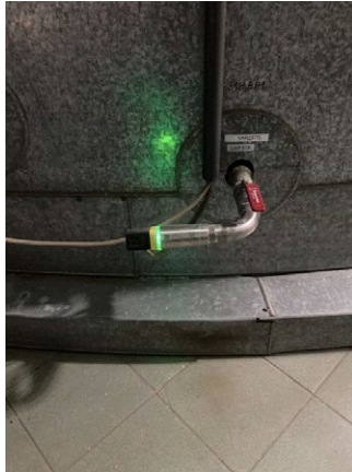
Měření hladiny v pivním tanku VEGABAR 29
