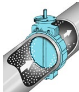
Klapka netěsní kvůli opotřebeně těsnění.
