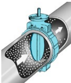
Opotřebeně těsnění – narušené abrazí.
