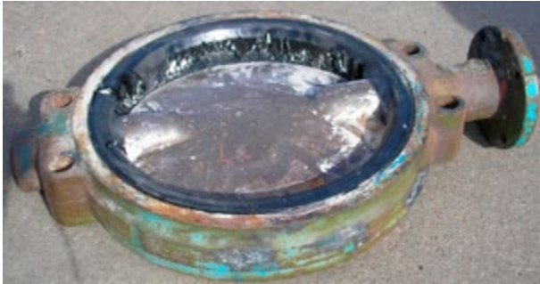
Motýlové klapky jsou navrženy pro přepravu plynů a kapalin. Abrazivnost suchých sypkých látek narušuje strukturu a těsnění klapky.
