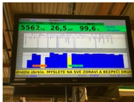
Obr. 6: Terminál COMES OEE pro řízení a hodnocení efektivity balicích linek v Kosteckých uzeninách a motivační TV výrobního týmu linky v závodu Mondelez Opava.
