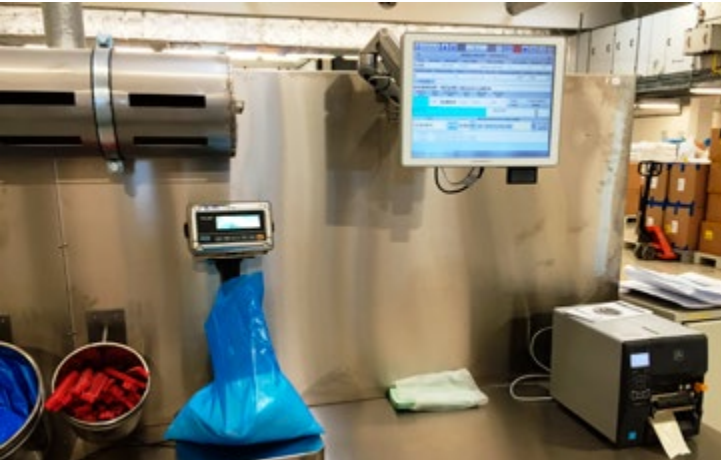
Obr. 2: Řízení navažovny a dávkování surovin systémem COMES ve společnosti Hügli Food
