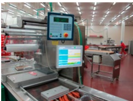
Obr. 6: Terminál COMES OEE pro řízení a hodnocení efektivity balicích linek v Kosteckých uzeninách a motivační TV výrobního týmu linky v závodu Mondelez Opava.
