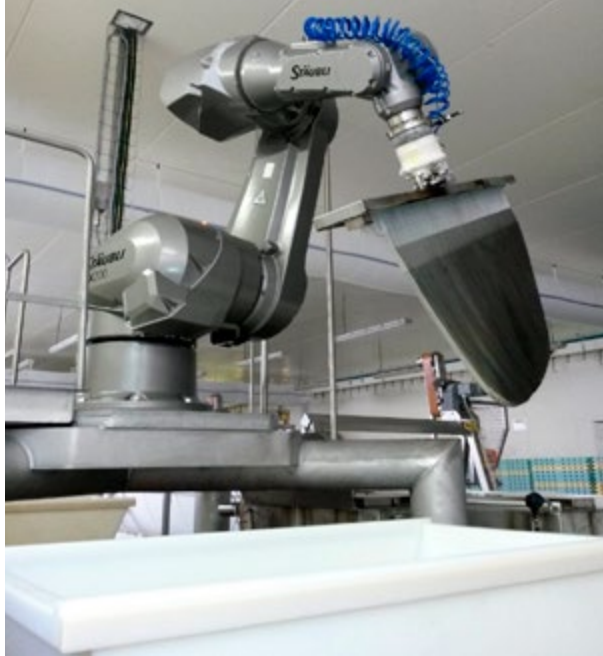
Obr. 5: Aplikace robota Stäubli ve výrobě sýrů v mlékárně Savencia/Pribina Přibyslav
