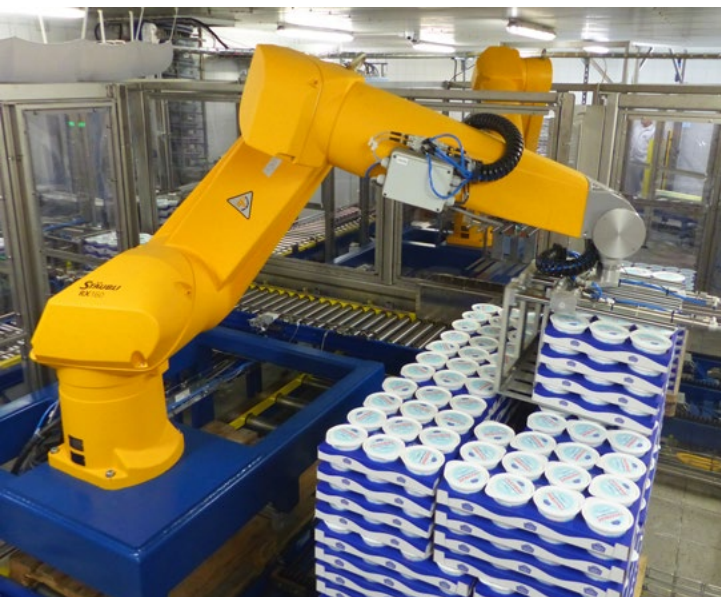
Dva roboty Stäubli zvládnou připravit dohromady 11 palet pomazánek každou hodinu.
