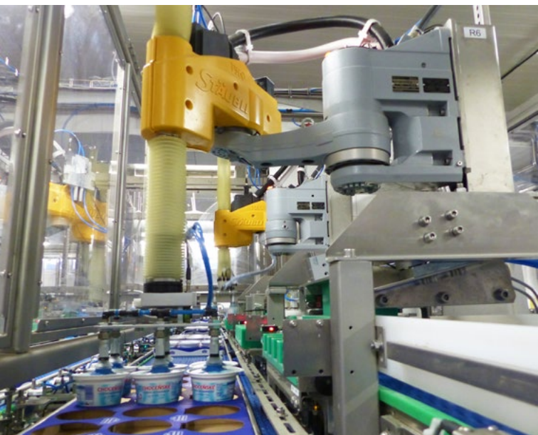
Robotická balicí linka zvládne 20 tisíc pomazánkových másel za hodinu.
