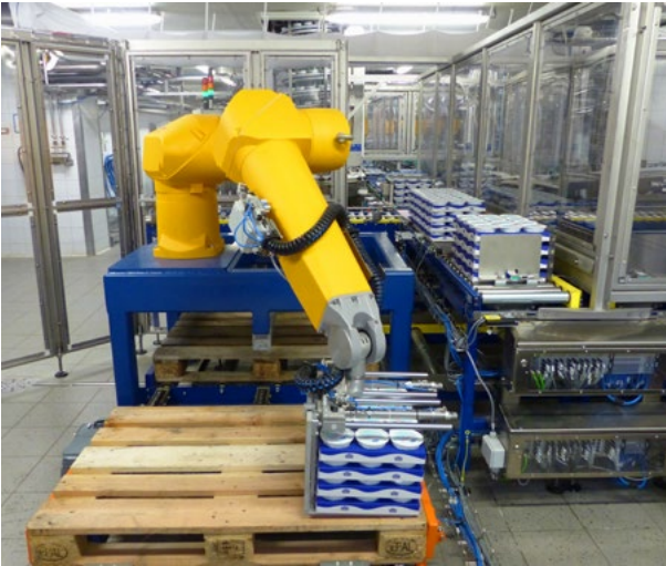
Šestiosý robot RX160 využije při paletizaci celý svůj dosah.
