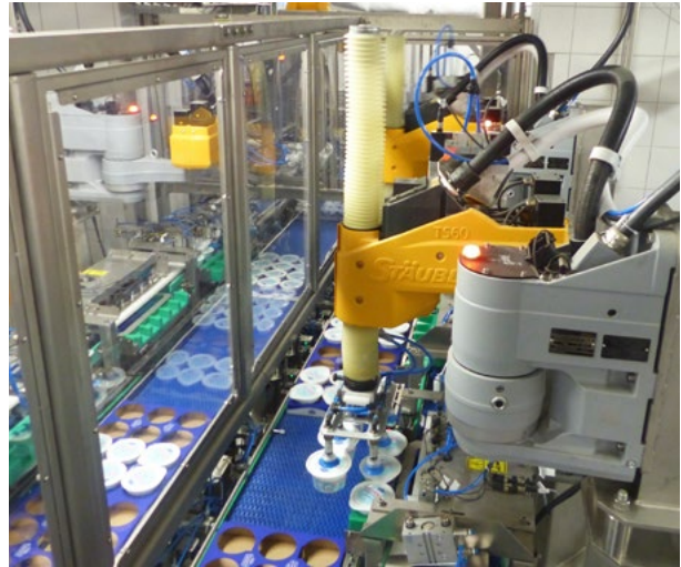
O skládání kelímků do plat se starají celkem čtyři SCARA roboty Stäubli TS60.
