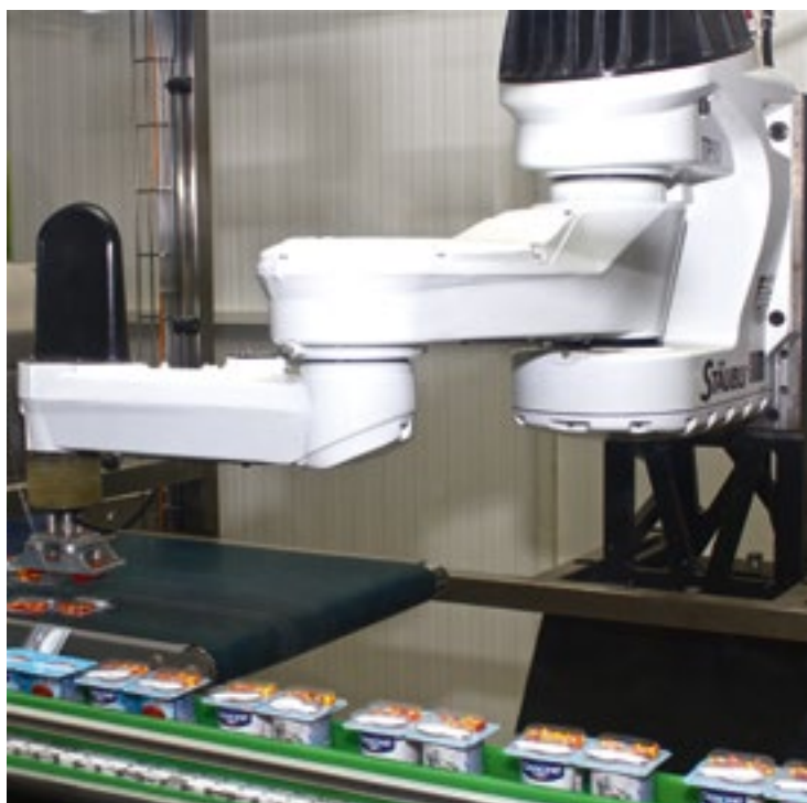
Vzhledem k naměřené nejvyšší rychlosti 237 operací přemístění (pick & place) za minutu robot FAST picker výrazně překonává požadovanou rychlost 220 operací.
