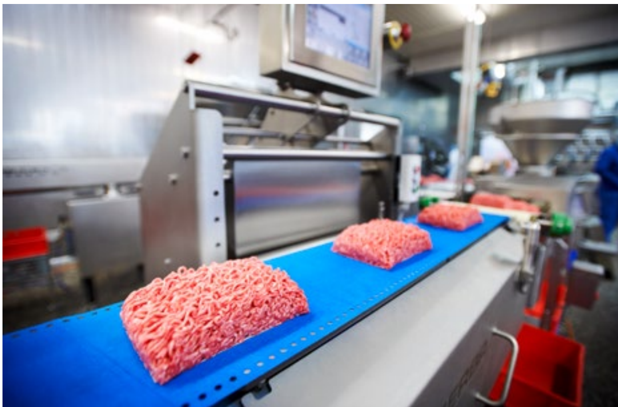
Procesní váha s integrovanou rozváděčovou skříní Hygienic Design společnosti Rittal.
