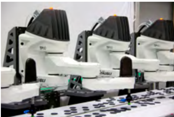
Aplikace přemístování se čtyřmi roboty TP80 na lince.
