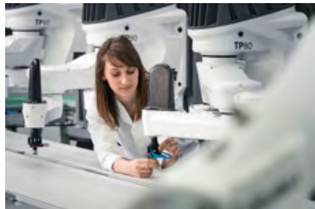
Pracovnice kontroluje chapadlo na zdvihové části ramene.
