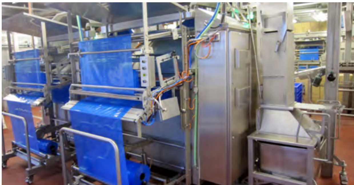
Rozváděčová skříní řady Hygienic Design společnosti Rittal integrovaná do výrobní linky společnosti OSI.
