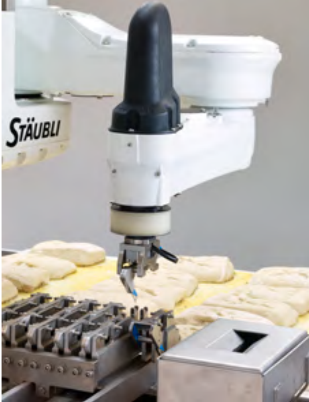
Přesné nařezávání příchozích pekárenských produktů podle předem definovaných parametrů.
