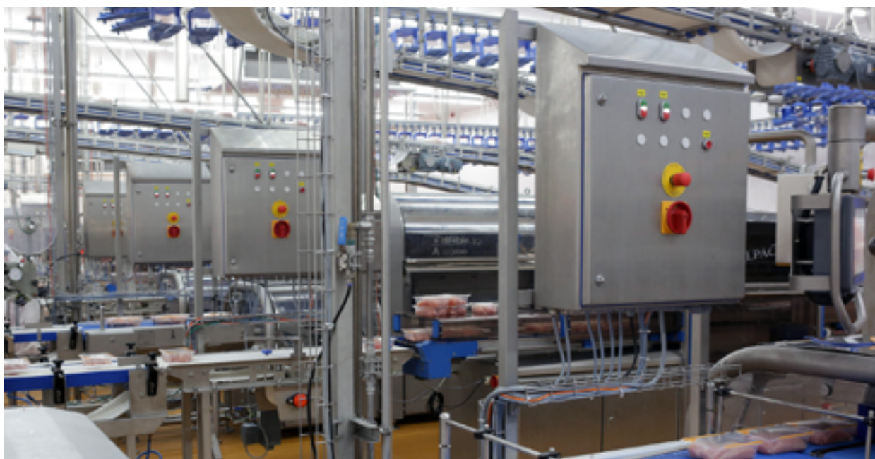
Balící linka s integrovanou rozváděčovou skříní Hygienic Design společnosti Rittal pro ochranu řídicí elektroniky v potravinářském provozu.
