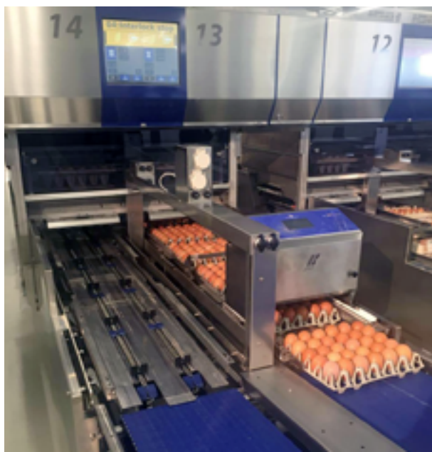
▲ Automatické balící dráhy umožňují balit vytříděná a označená vejce do proložek nebo do malospotřebitelských obalů.
