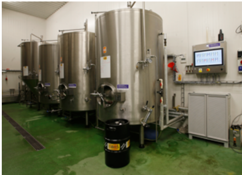
Kvasné tanky napojené na I/O systém u-remote v pivovaru Antoš ve Slaném.
